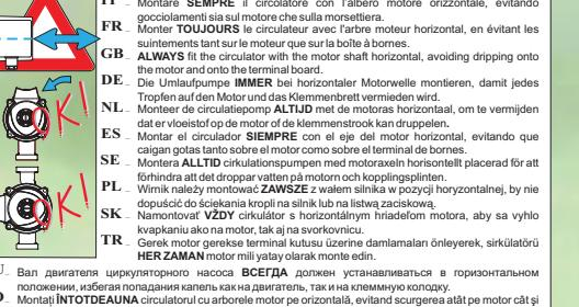
**IT** Montare SEMPRE il circolatore con l'albero motore orizzontale, evitando gocciamenti sia sul motore che sulla pompa.
